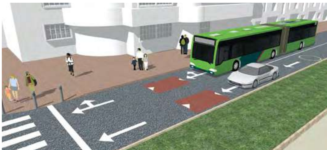
Almofadas atenuadoras de velocidade podem permitir que veículos de eixos largos passem sobre a almofada, melhorando o conforto dos passageiros de ônibus
