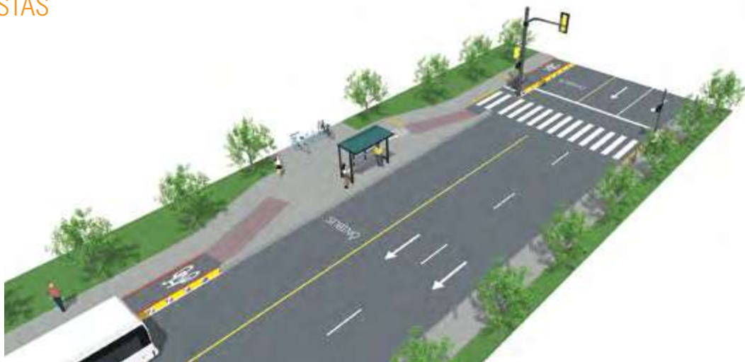
O desenho da ciclovia deve acomodar as necessidades dos ciclistas e dos pedestres em um ponto de ônibus
