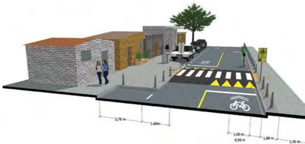
Via compartilhada com bicicletas usando sinalização horizontal e medidas de moderação do tráfego
