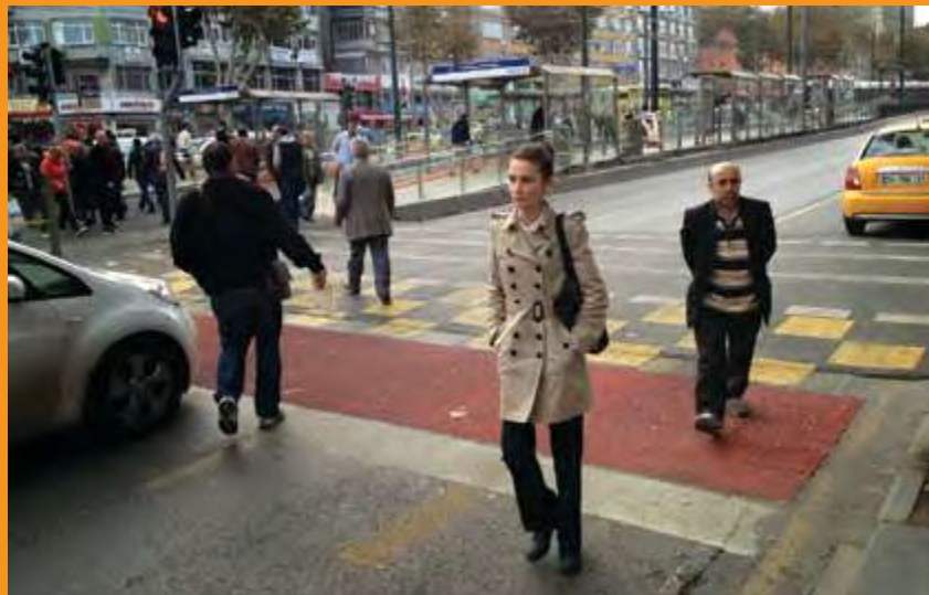
Uma travessia elevada em Istambul dá prioridade aos pedestres em um ponto de acesso a uma estação de bondes.
