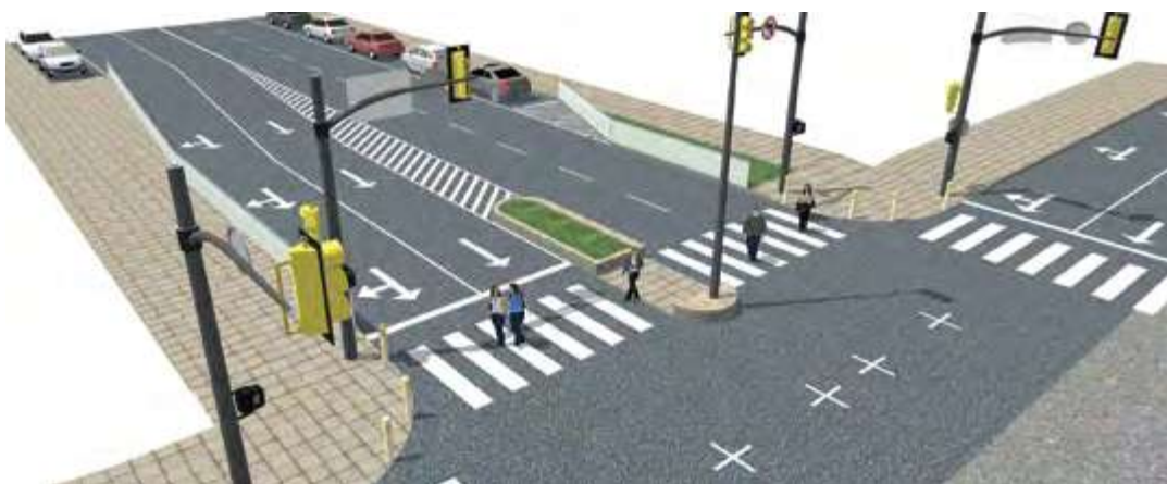
Refúgio no canteiro central sem continuidade do canteiro
